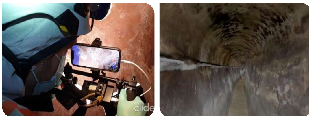
Figure 10 : Agent effectuant une captation de données en réseau d'assainissement et exemple de modèle mesh du réseau produit avec la technologie V3
