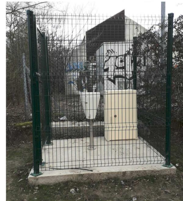
\*La crête d'entonnement doit être implantée à une hauteur de plus d'1 m et doit être plus haute que l'armoire électrique
